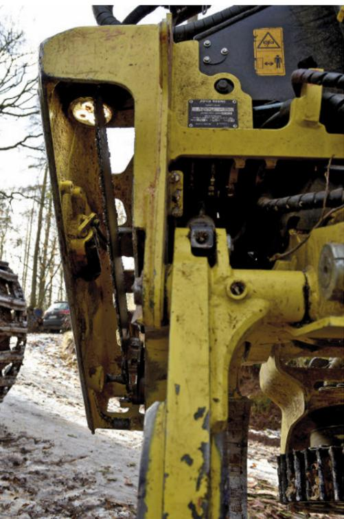
Lauers Aggregat H415 besitzt ein Farbmarkierungssystem sowie einen beleuchteten Sägekasten. Fotos: Jan Biernath
